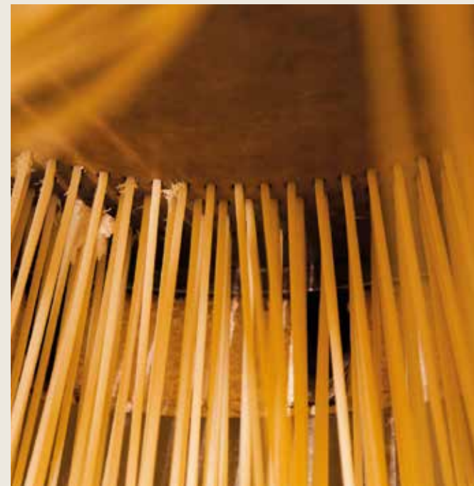
Spaghetti Mancini in uscita dalla trafile in bronzo durante l'estrusione. Spaghetti Mancini exit from the bronze die during the extrusion process.
