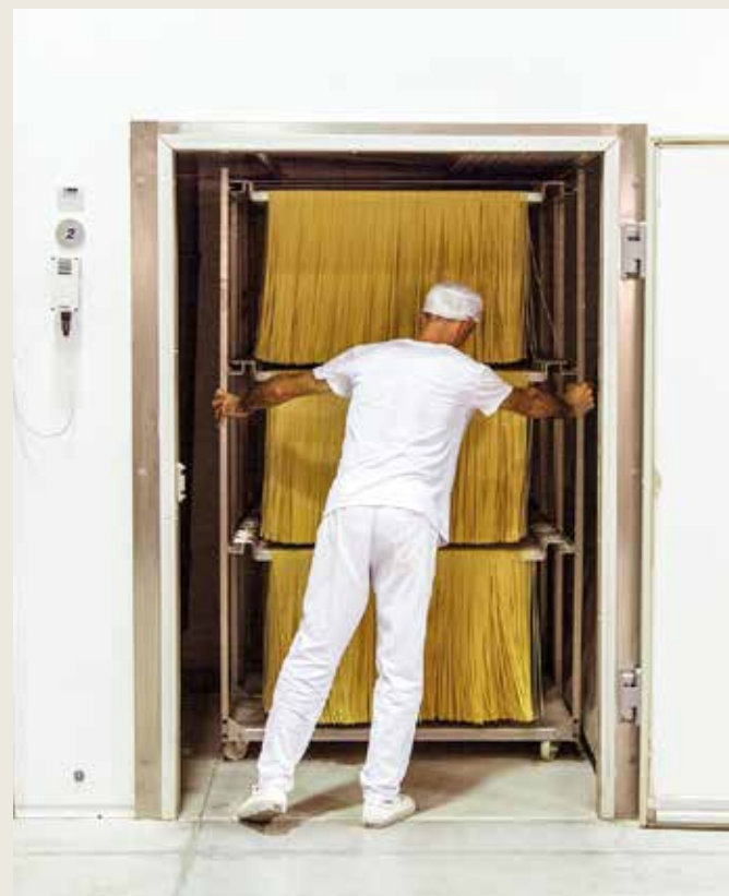
Gli Spaghetti Mancini ancora ricchi di acqua dell'impasto mentre vengono riposti dal pastaio nella cella per la loro essiccazione, lenta e a bassa temperatura. Still rich in dough's water Spaghetti Mancini during the transfer to the cell for the slow, low temperature drying process.
